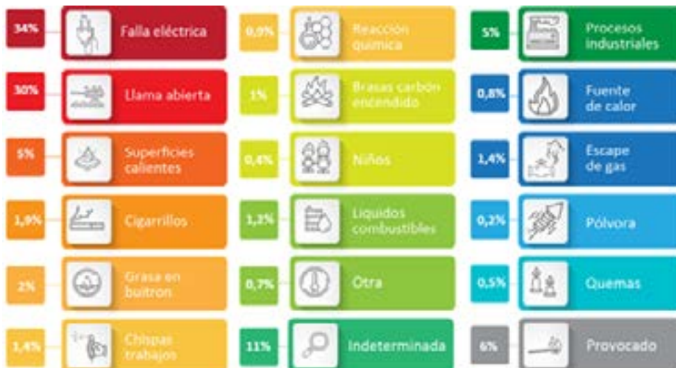
Causas asociadas a la ocurrencia de incendios estructurales
